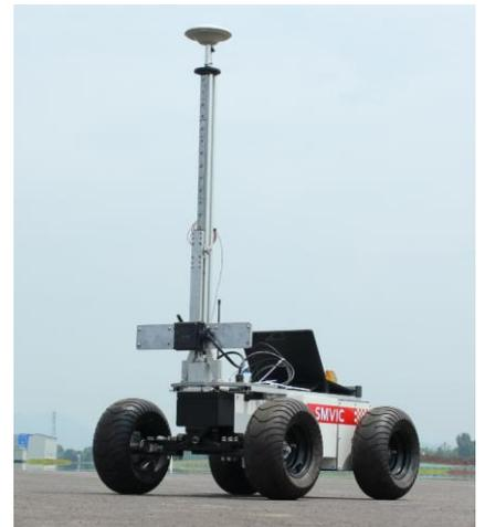
雷达 RCS 测试系统，用于无人驾驶目标物雷达参数性能测试，通过专用化软件控制测试车辆，可对目标物进行径向或圆周方向雷达测量，测量过程数据可实时进行保存。整车通过标准 CAN 协议进行控制驱动，搭载工控机、雷达系统、高精度 GPS 测试系统。机身底盘采用高功率伺服电机，四轮驱动，差速转向，可根据设定轨迹进行自适应路径跟随闭环测试，运动轨迹综合偏差小于 2cm。
